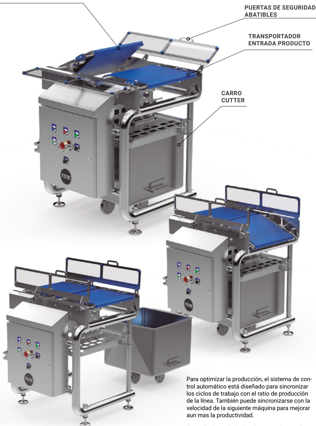
Para optimizar la producción, el sistema de control automático está diseñado para sincronizar los ciclos de trabajo con el ratio de producción de la línea. También puede sincronizarse con la velocidad de la siguiente máquina para mejorar aun mas la productividad.
