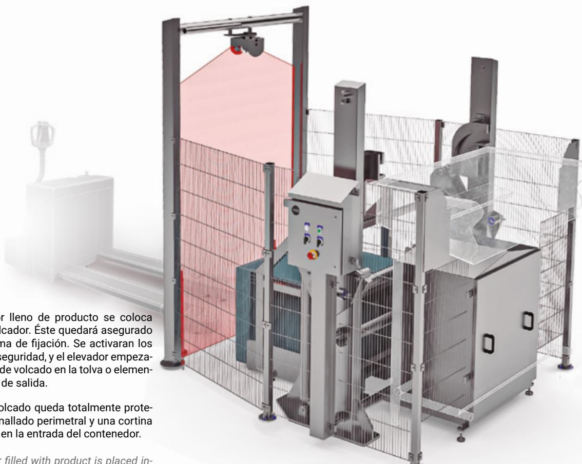
El contenedor lleno de producto se coloca dentro del volcador. Éste quedará asegurado con un sistema de fijación. Se activaran los sistemas de seguridad, y el elevador empezará el proceso de volcado en la tolva o elemento designado de salida.
